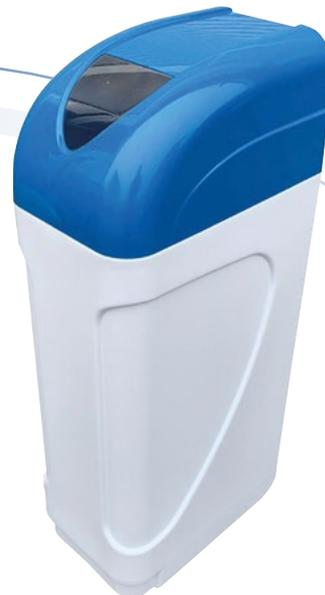
Kompakte Einzelenthärtungsanlage mit einem Filterbehälter aus GKF, gefüllt mit Spezialaustauscherharz und aufgesetztem Steuerventil inkl. eingebauter Verschneideeinrichtung für automatische Regeneration. Die Regeneration wird vollautomatisch durch ein mikroprozessor-gesteuertes Programmwerk mit Impulswasserzähler nach Erreichen einer voreingestellten Wassermenge eingeleitet und ausgeführt.
